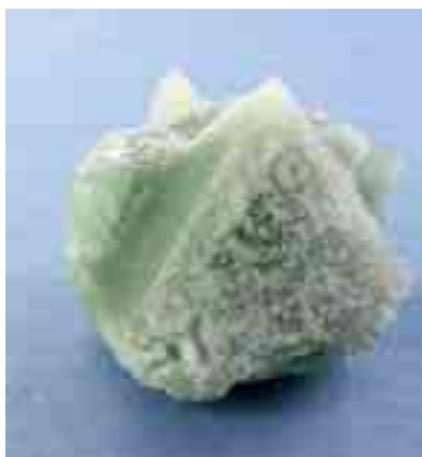
Фторид кальция образует бесцветные кристаллы, трудно растворимые в воде и неконцентрированных кислотах
